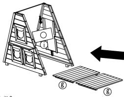
Schritt 3: Schieben Sie den Boden, bestehend aus zwei Teilen (g), zwischen Vorder- und Rückwand ein und setzen Sie die Trennwand (i) aufrecht in die dafür vorgesehene Aussparung in der Mitte ein.
