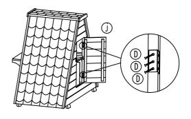
Schritt 6: Befestigen Sie die Tür (j) an der Rückseite. Schrauben Sie hierfür die Scharniere mit Hilfe von je 3 Schrauben (D) fest.
