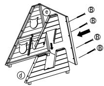
Schritt 2: Setzen Sie die Rückwand aus den Teilen (d) und (e) zusammen und schrauben die Teile mit 4 Schrauben (B) ebenfalls an dem schrägen Dach (a) fest.
