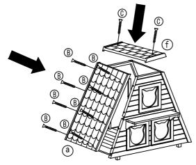
Schritt 5: Befestigen Sie das zweite Teil des schrägen Dachs (a) mit Hilfe von 8 Schrauben (B) an Vorder- und Rückwand fest. Setzen Sie das obere Dachstück (f) auf und schrauben es mit 2 Schrauben (C) fest.
