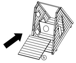
Schritt 4: Schieben Sie den oberen Boden (h) zwischen Vorderund Rückwand ein, sodass eine zweite Ebene entsteht.
